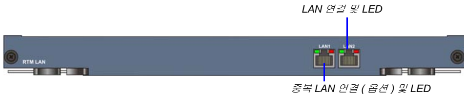
그림 1-13 RMX 4000 RTM LAN 뒷면 패널 레이아웃
